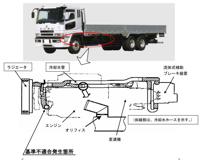
変速機に装着されている流体式補助制動装置の冷却水ホースの耐久性が不足しているため、走行時の振動等により亀裂が発生し、また、ホースが抜けるものがある。 そのため、そのままの状態で使用を続けると、エンジン冷却水が大量に流出し、 最悪の場合、エンジンが焼付き、走行不能となるおそれがある。
