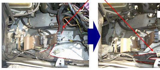
(注) 下段の写真は、便宜上、クーラントタンクとフューズボックスを取り外しています。
