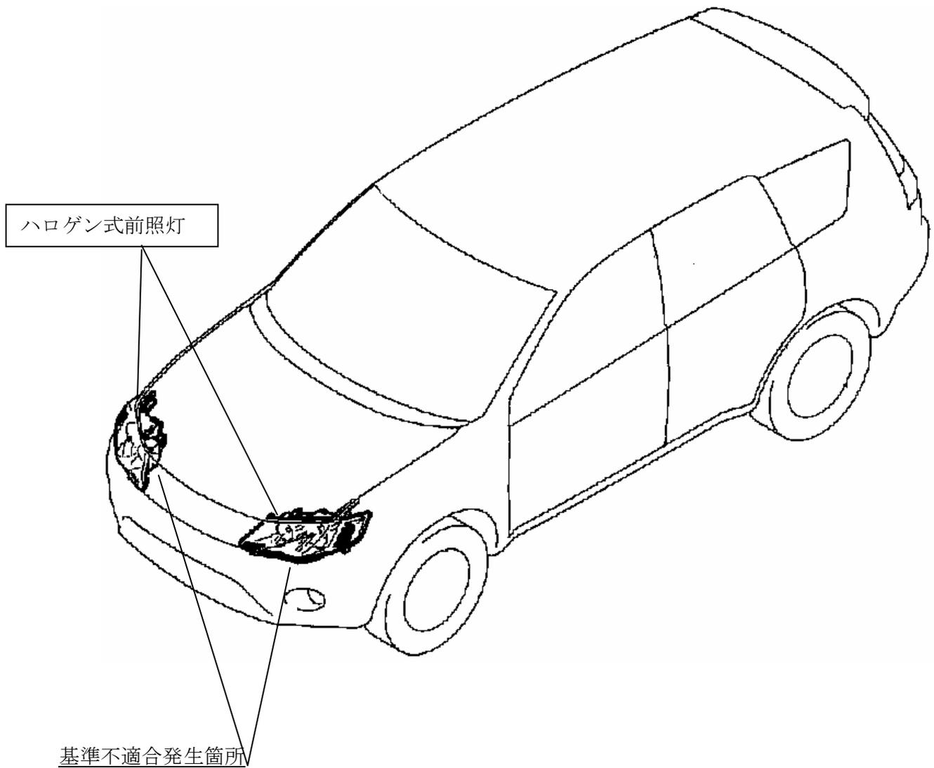
ハロゲン式前照灯装着車において、すれ違い用前照灯の光軸調整検査が不適切なため、照射方向が基準から外れたものがある。そのため、前照灯に係わる保安基準に適合しないおそれがある。
