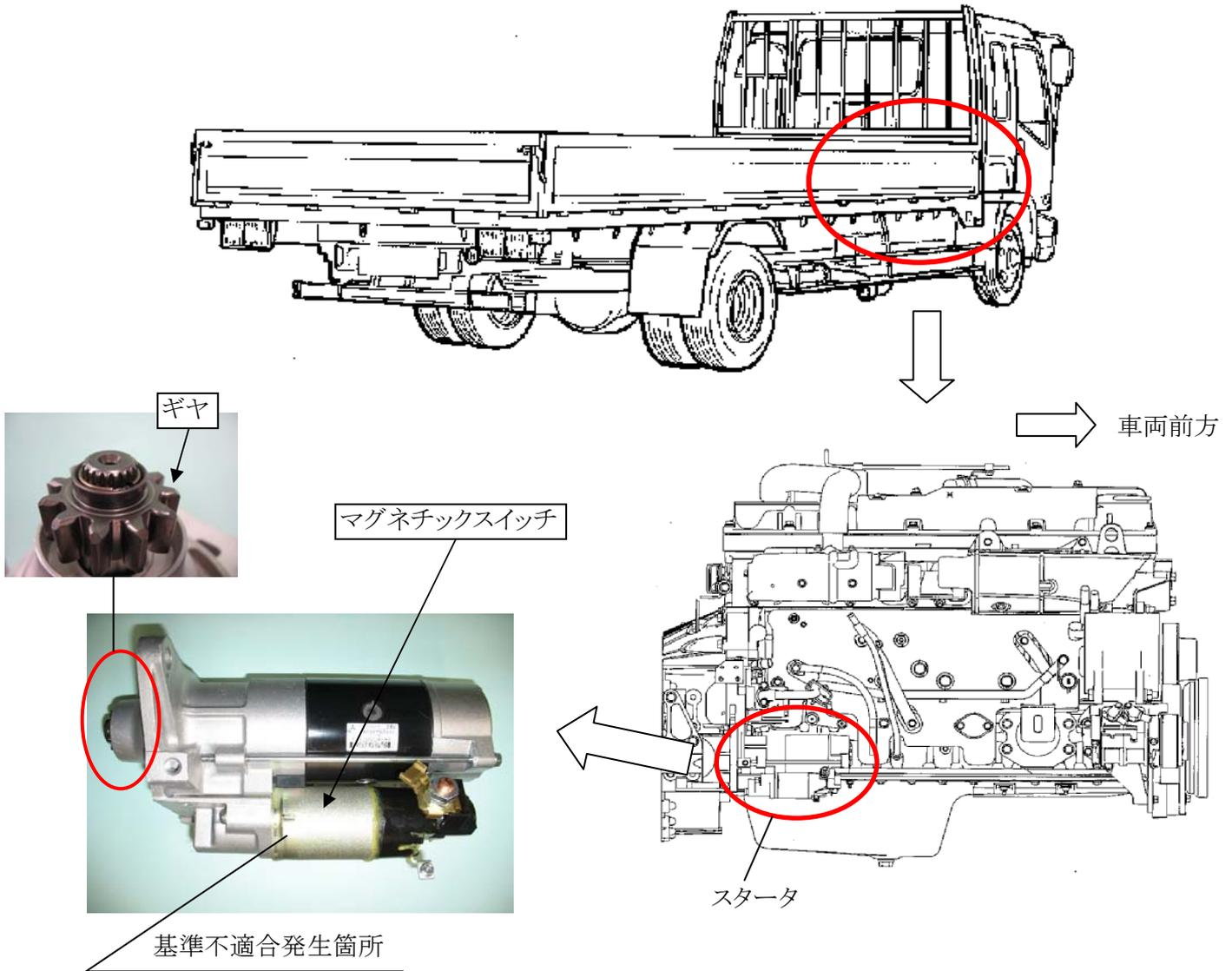
始動装置を繰り返し操作した場合、マグネチックスイッチ（スタータモータのギヤをエンジンにかみ合わせる装置）内部に可燃性のガスが発生し、滞留することがある。そのため、当該ガスに火花が着火して焼損し、最悪の場合、火災に至るおそれがある。
