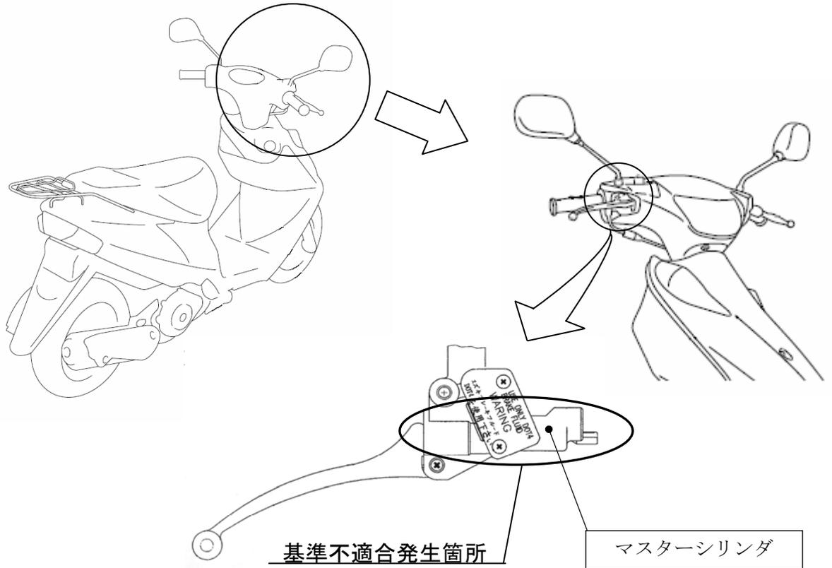
前輪ブレーキ用のマスターシリンダにおいて、セカンダリピストンシールの組み付けが不適切なため、正規位置に組み付けられていないものがある。そのため、ブレーキ操作を続けるとブレーキ液が漏れて、最悪の場合、制動力が低下するおそれがある。
