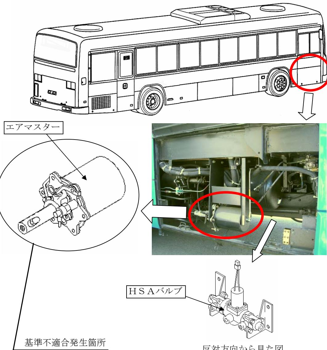
大型路線バスの制動装置において、ブレーキ液に混入した異物により、倍力装置からブレーキ液が漏れることがある。そのため、そのまま使用を続けると、坂道発進補助装置（HSA：ヒル・スタート・エイド）の制御バルブのゴム部品が膨潤して、最悪の場合、ブレーキが解除できなくなるおそれがある。
