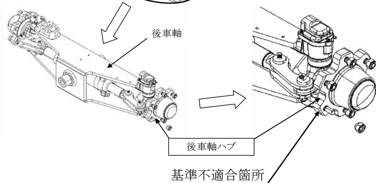
フォークリフトおよびショベルローダの後車軸ハブへのボルト圧入工程において圧入装置の治具が不適切なため、当該ハブに亀裂が生じているものがあり、堅ろう性が確保されないおそれがある。
