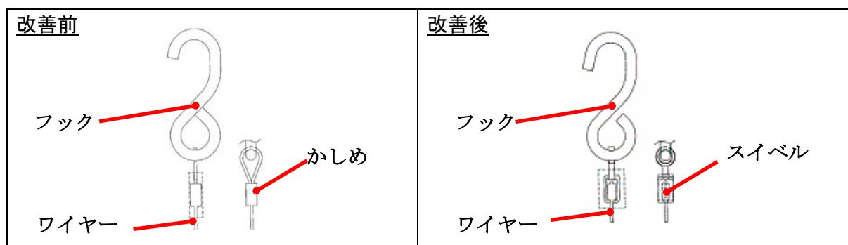
識別：フックとワイヤー締結部のスイベル機構の有無で識別する。
