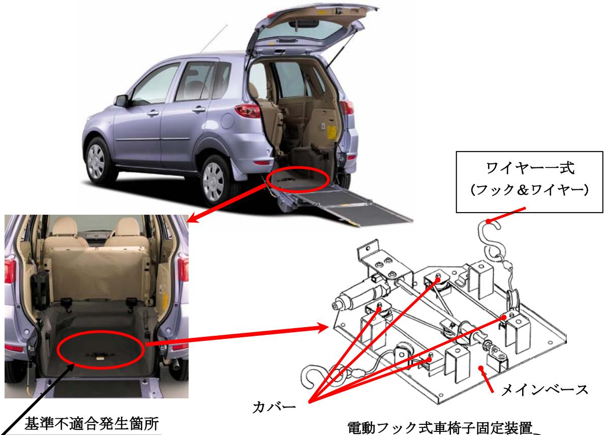
スロープ式車いす移動車において、車いす固定用ワイヤーがねじれやすいため、ワイヤーを滑車に保持するためのカバーが動き、ワイヤーが滑車から外れる場合がある。そのため、ワイヤーがカバーと干渉し、最悪の場合、ワイヤーが切れて車いすを固定できなくなるおそれがある。
