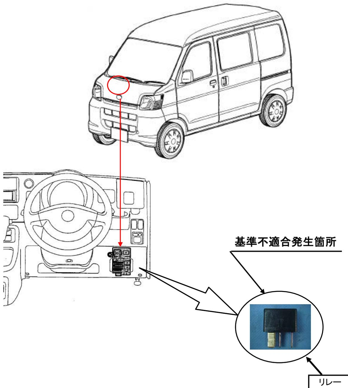
圧縮天然ガス車(CNG車)および液化石油ガス車(LPG車)において、ガス遮断弁を作動させるリレーの接点部に炭化物の被膜が形成され、電気抵抗が増加する場合があります。そのため、そのままの状態で使用を続けると、ガス遮断弁が開かず、最悪の場合、走行中原動機が停止し、再始動できなくなるおそれがある。
