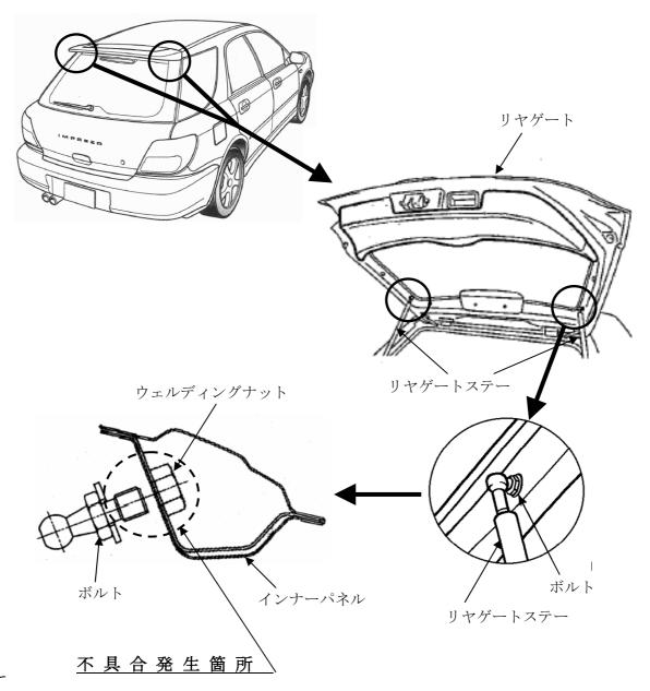
跳ね上げ式リヤゲートに取り付けられているリヤゲートステー取付用ボルトの締付けトルクが不足しているものがある。そのため、リヤゲート開閉操作の繰り返しによって、リヤゲートステー取付部が破損して、リヤゲートが降下し身体の一部に当たるおそれがある。
