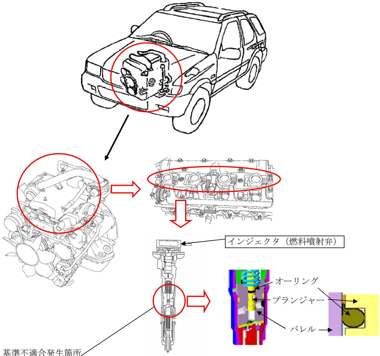
原動機の燃料噴射装置において、インジェクタ（燃料噴射弁）の設計寸法が不適切なため、プランジャーとバレルの隙間が大きいものがあり、オーリングが変形、損傷して気密性が損われ、燃料の軽油がエンジンオイルに混入するものがある。そのため、そのままの状態で使用を続けると、オイルパンの油量が増大し、プローバイホースを経由して吸気管に軽油の混入したオイルが吸入され、原動機の回転が上昇するおそれがある。
