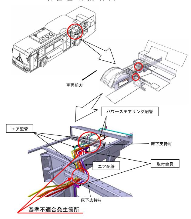
大型路線バスのエア配管及びパワーステアリング配管の配置が不適切なため、当該配管が車体後部の 床下支持材に接触するものがある。そのため、そのままの状態で使用を続けると、車体の振動等により、 ①エア配管が損傷し、エアが漏れ、警音器が作動せず、最悪の場合、制動力が低下するおそれがある。
