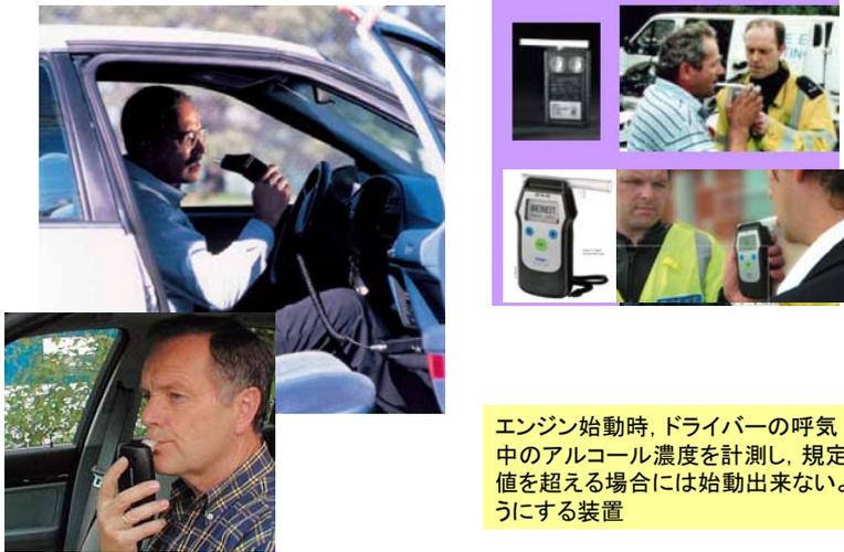
エンジン始動時, ドライバーの呼気中のアルコール濃度を計測し, 規定値を超える場合には始動出来ないようにする装置
