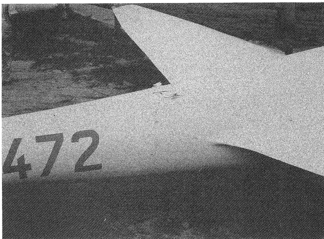
写真 1 胴体中央部右側損傷状況
