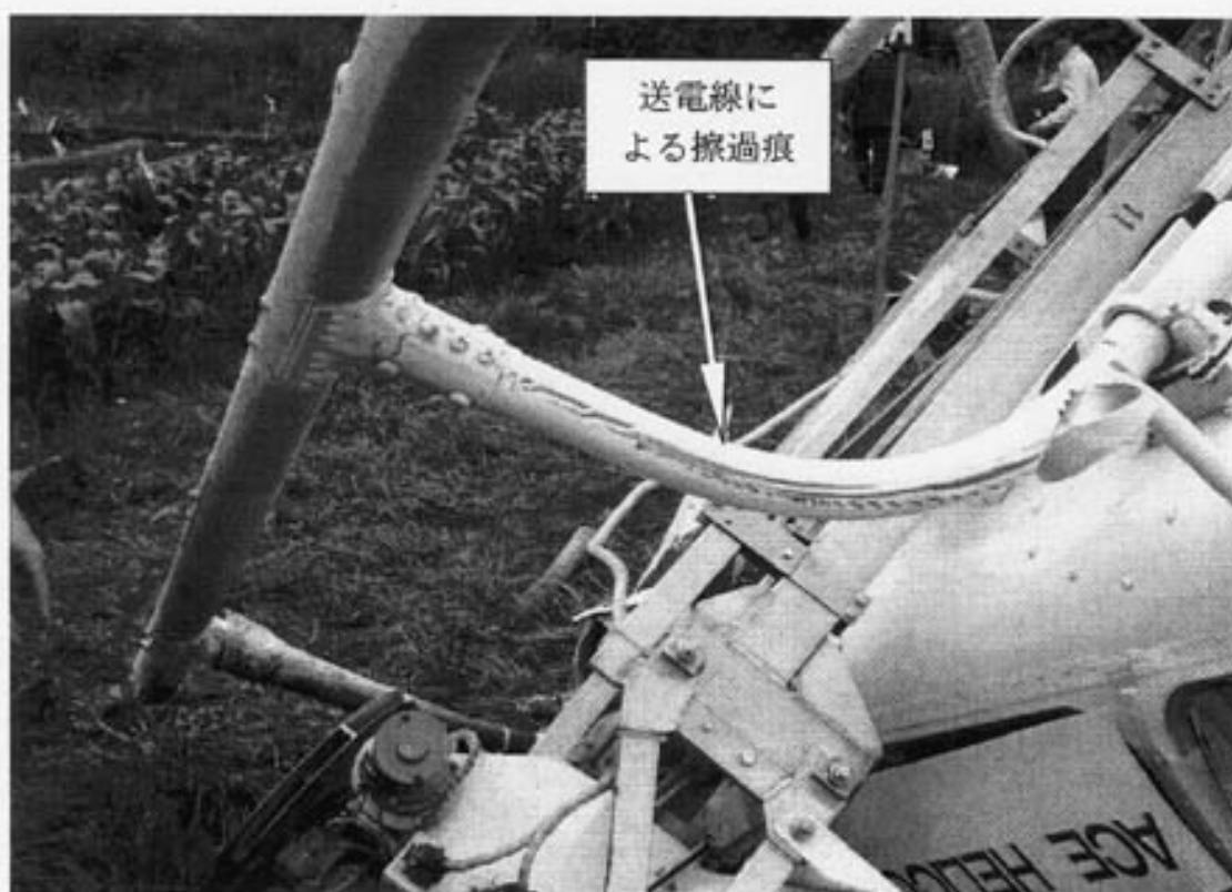
写真2 クロスチューブの送電線擦過痕
