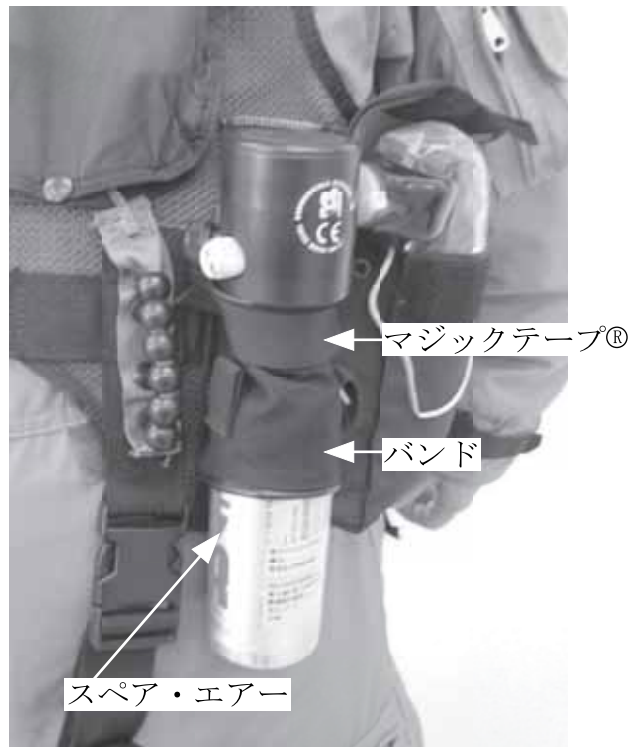
写真6 スペア・エアー取付け状況
