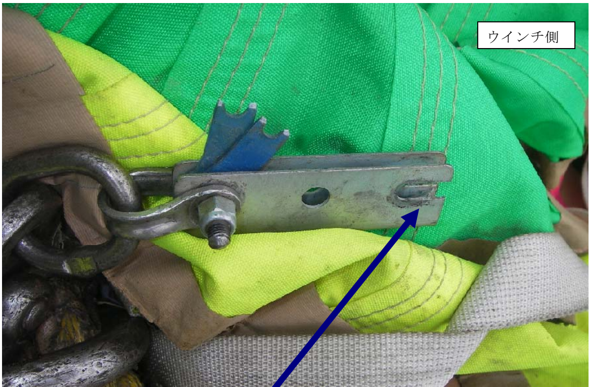
写真3 破断した曳航索安全装置
