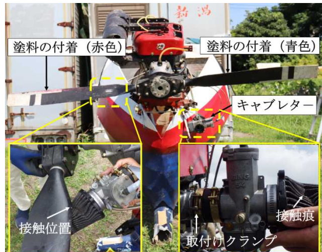
図2 脱落したキャブレター
