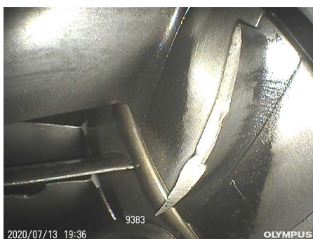
図2 根元から 1/4 で破断したブレード
