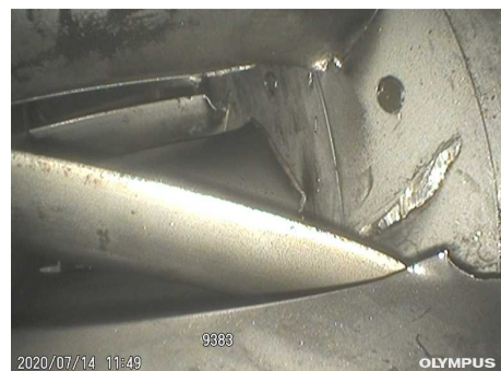
図3 大きく折曲したステーター
