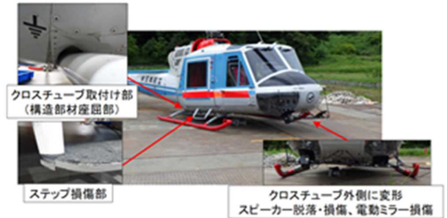
図1 主な機体損傷部
