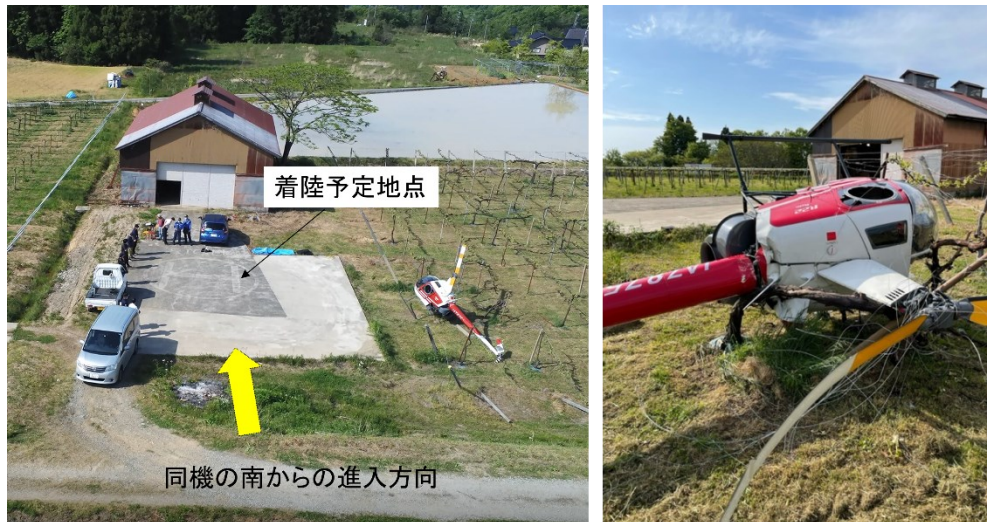
図 同機の横転状況
