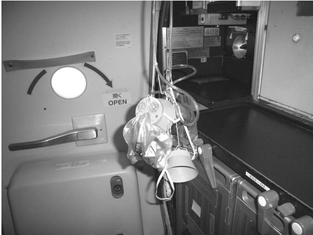
写真2 開いていた前方圧力軽減パネル
