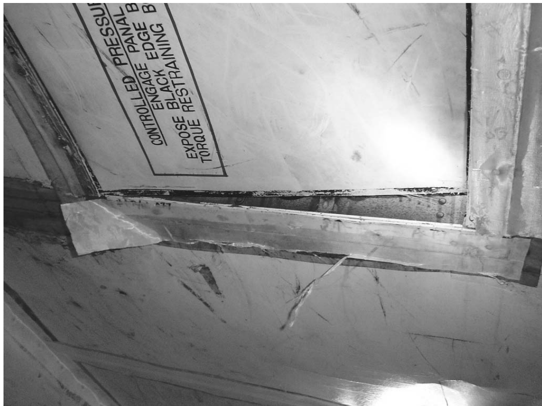
写真2 開いていた前方圧力軽減パネル
