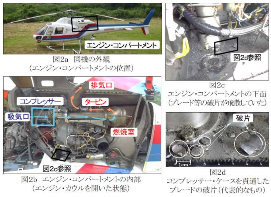
図2 エンジン・コンパートメント内部に飛散したブレードの破片
