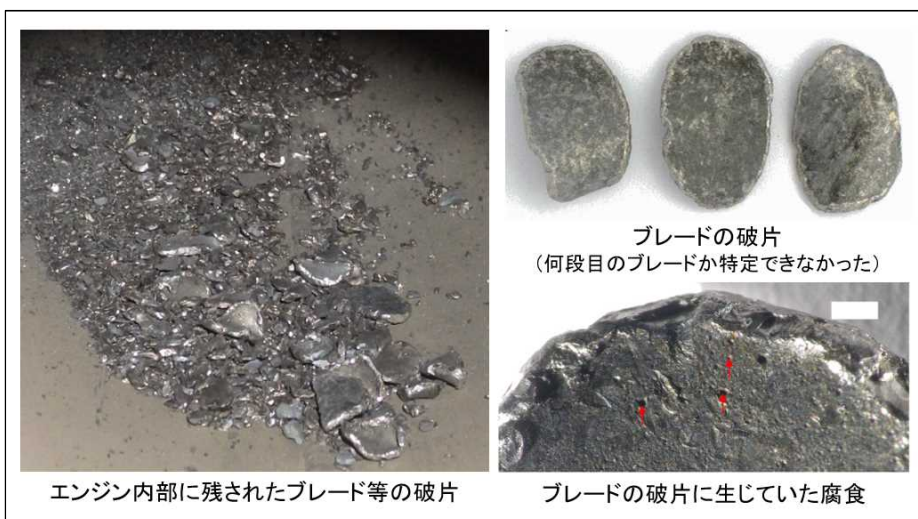
図9 エンジン内部に残されたブレードの破片の腐食
