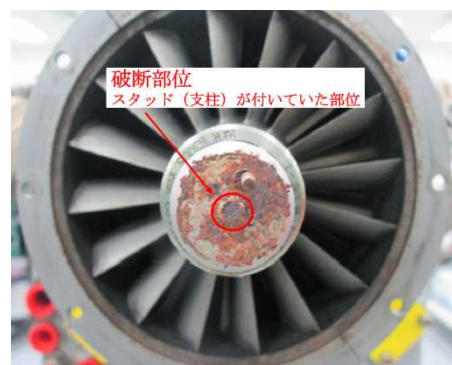
図 7 フロント・ベアリング・ハウジングの腐食
