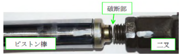
破断したピストン棒の接手ねじ
