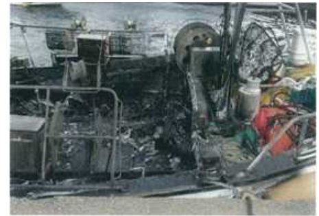
船首部の焼損状況
