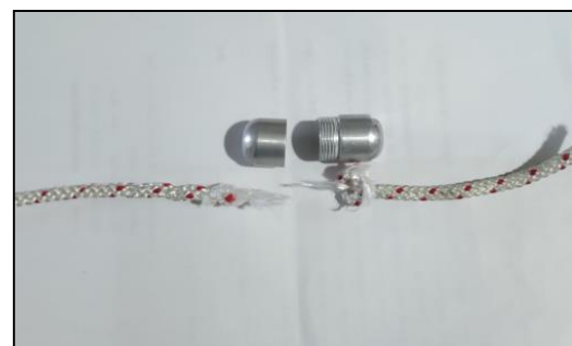
図6 結び目の位置で破断した状況（ストップ・エッグを開いた状態）
