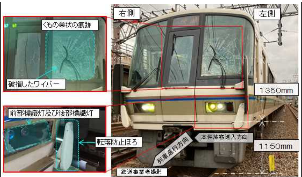
図5 車両の損傷状況
