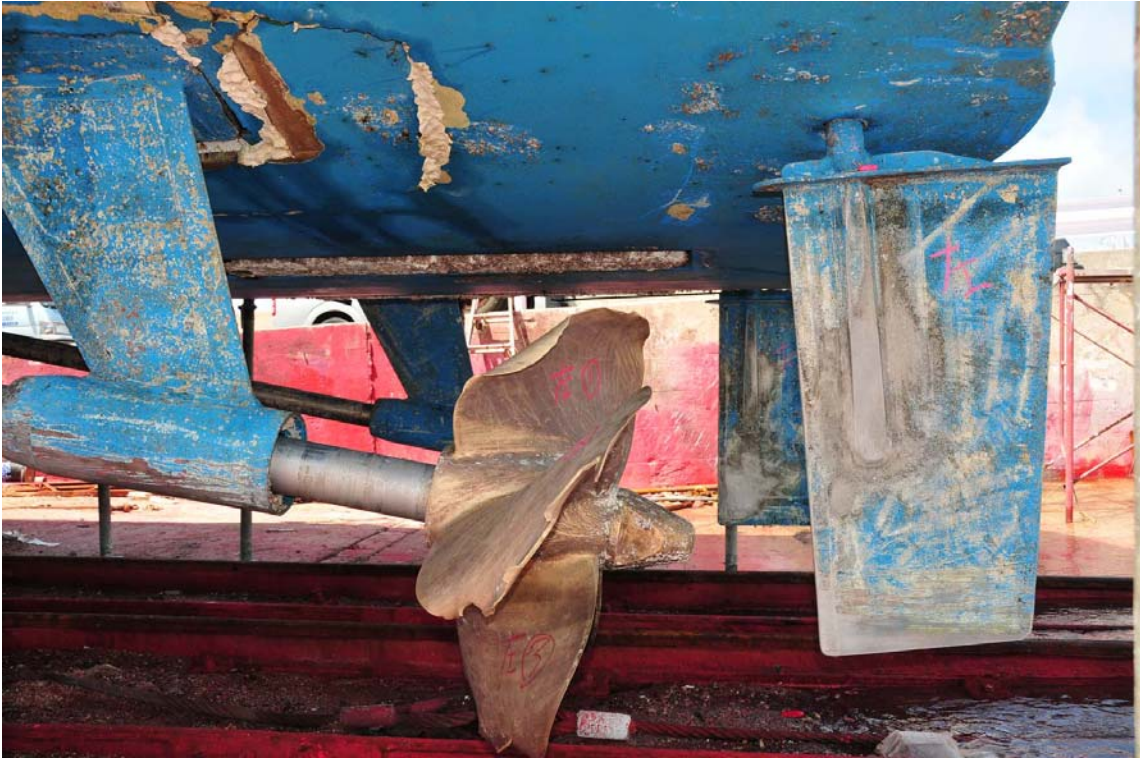
写真1 左舷船尾船底部の損傷状況
