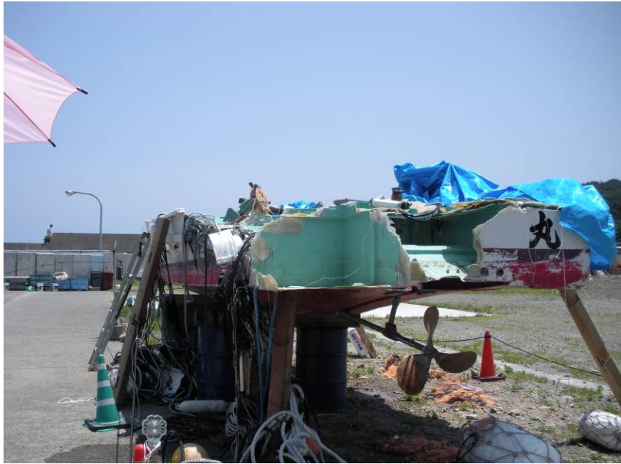
写真3 船尾の損傷状況
