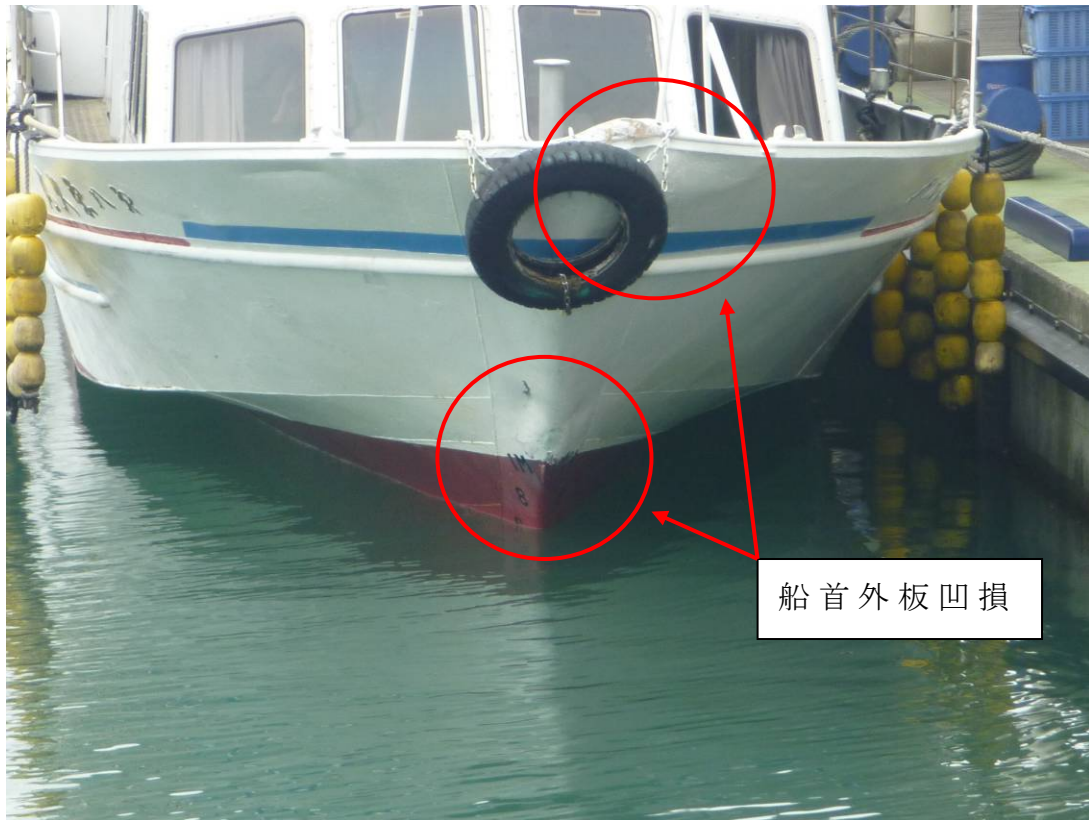
写真1 本船の損傷状況
