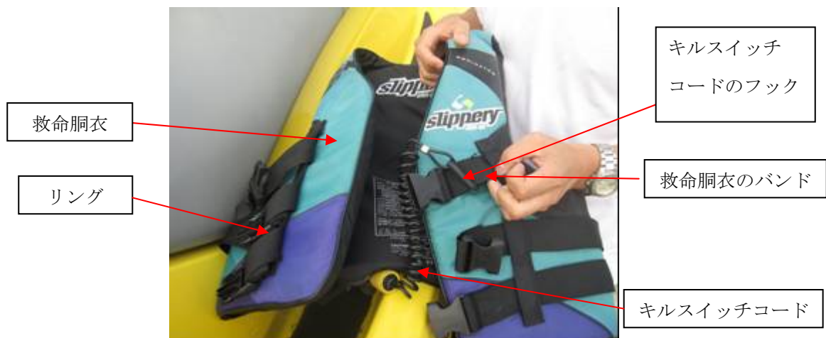
写真3 キルスイッチコードの取付状況（再現）
