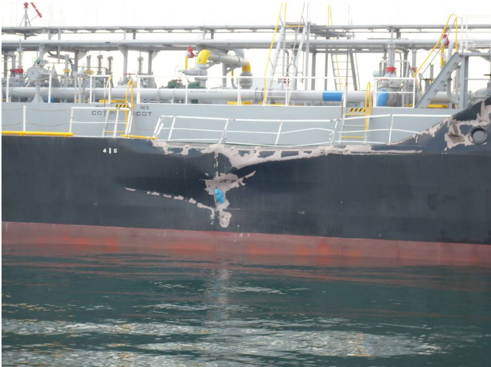
写真2 A船の損傷状況（左舷船尾部）
