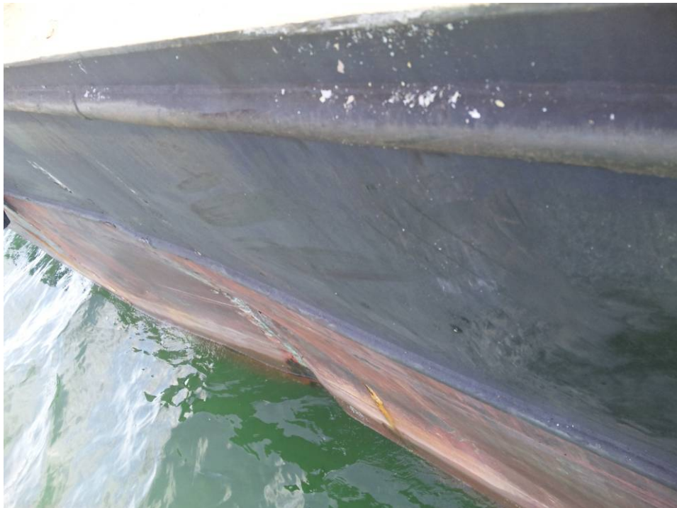
写真4 本件台船の損傷状況（左舷船首部）
