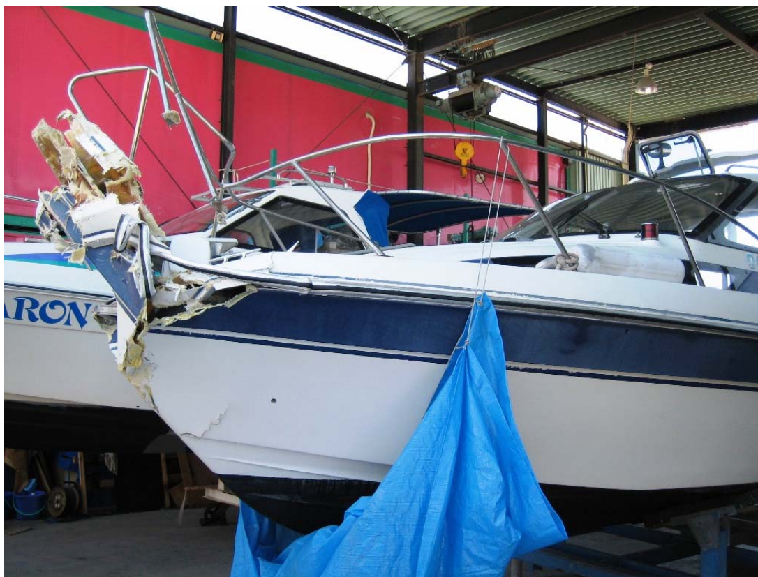
写真1 船首部損傷状況
