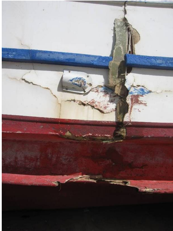
写真5 B船の損傷の状況（船体中央右舷側）
