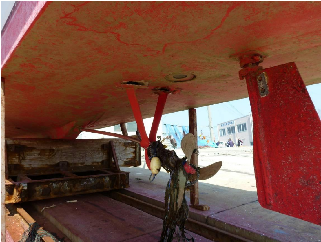
写真1 のり網のロープを巻き込んだプロペラの状況
