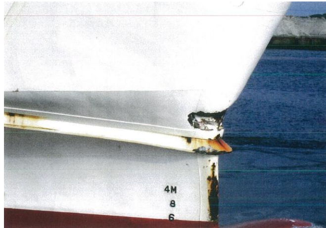
写真1 本船損傷部の状況
