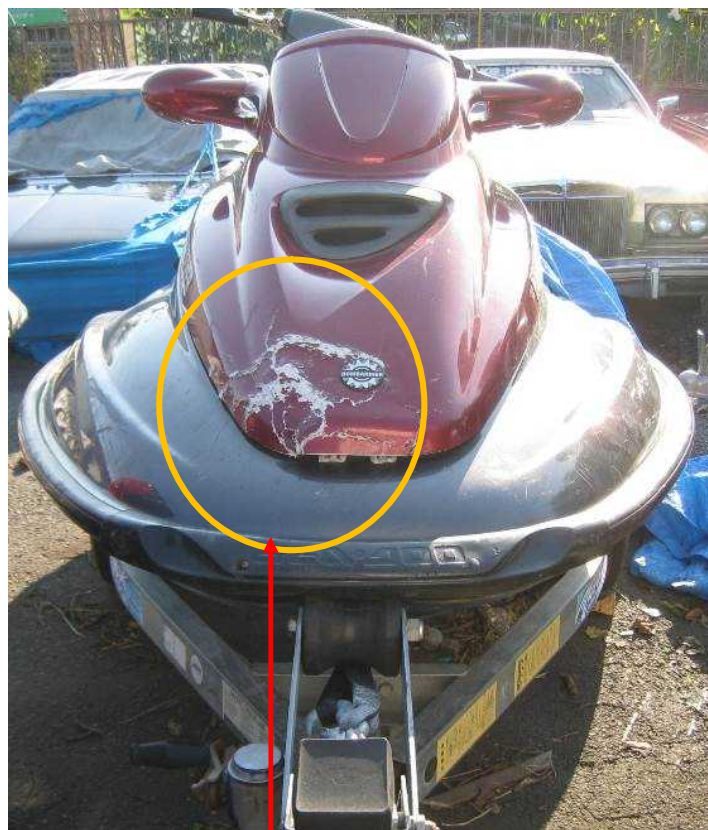
右舷船首部の亀裂
