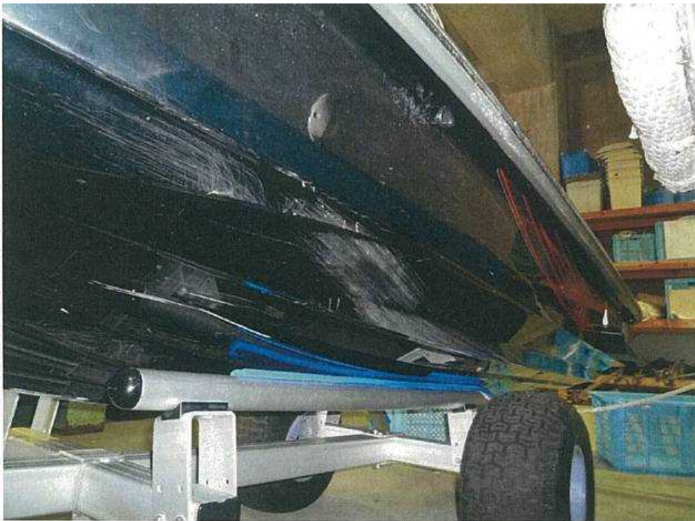
写真4 B船の損傷状況（左舷船底）
