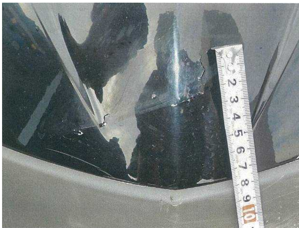
写真2 A船の損傷状況（船首部）
