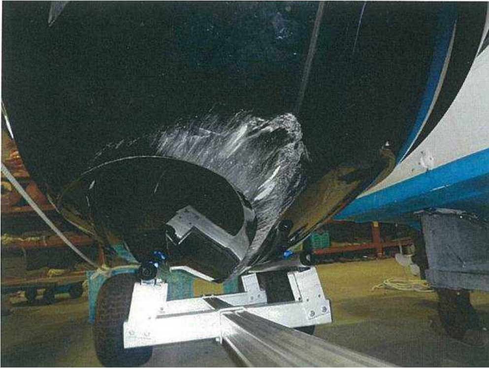
写真3 B船の損傷状況（船首船底）
