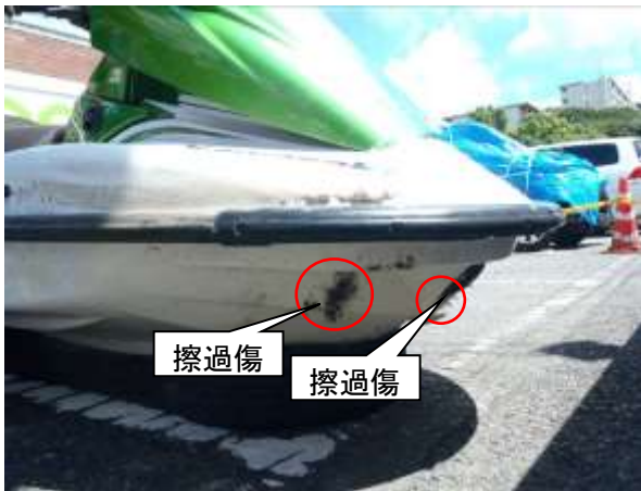
写真3 本船の損傷状況（右舷側）
