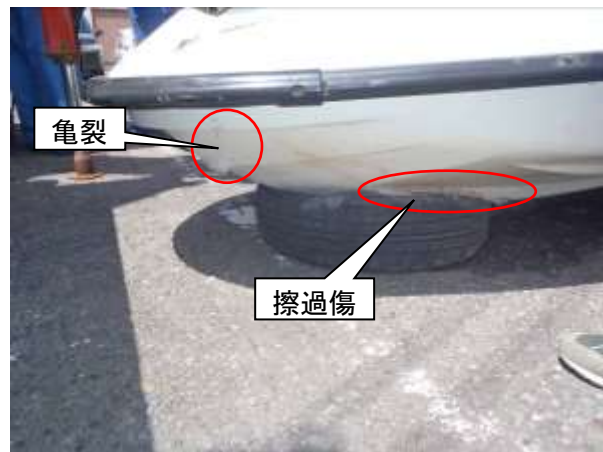
写真4 本船の損傷状況（左舷側）
