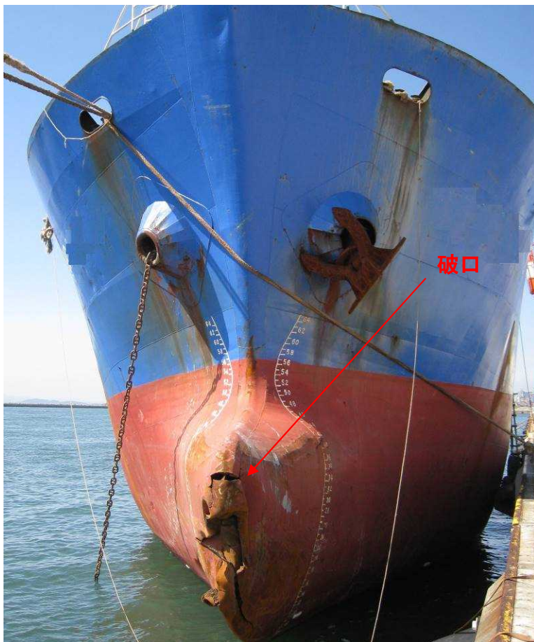
写真2 A船の損傷状況
