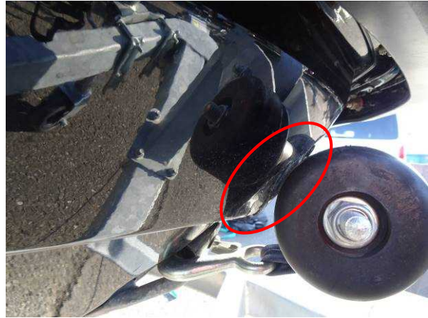
写真2 A船の損傷状況
