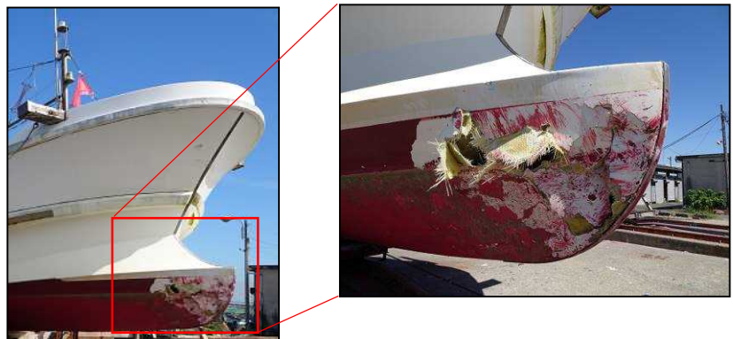
写真3 A船損傷状況
