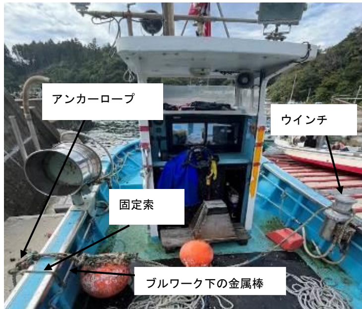
写真2 後部甲板の状況
