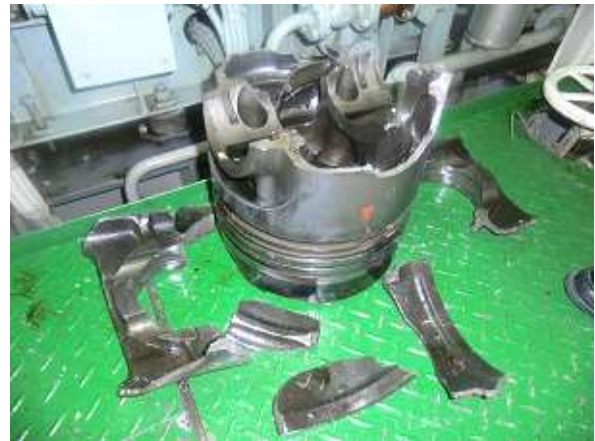
写真2 6番シリンダピストンの 破損状況
