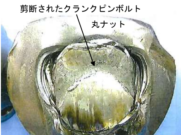
写真5 剪断されたクランクピンボルト (右舷側) 及び丸ナット
