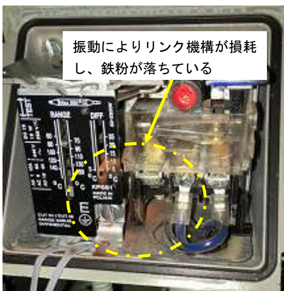
写真11 冷却清水温度スイッチの内部の状況
