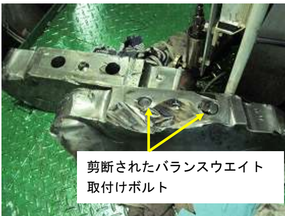
写真3 6番シリンダバランスウエイトの 脱落状況
