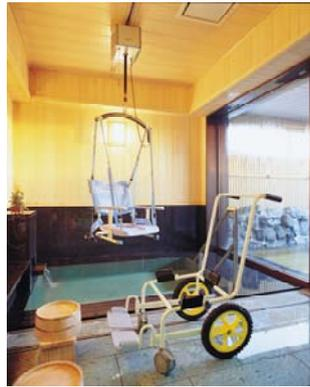
・手すり、階段、天井走行式の介助用リフトを設置した貸し切り浴室の例
