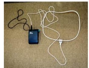
**K FM (2カ国) 赤外線誘導無線方式の同時通訳受信機とイヤホン (左)、磁気ループ用補聴器 (右)**
