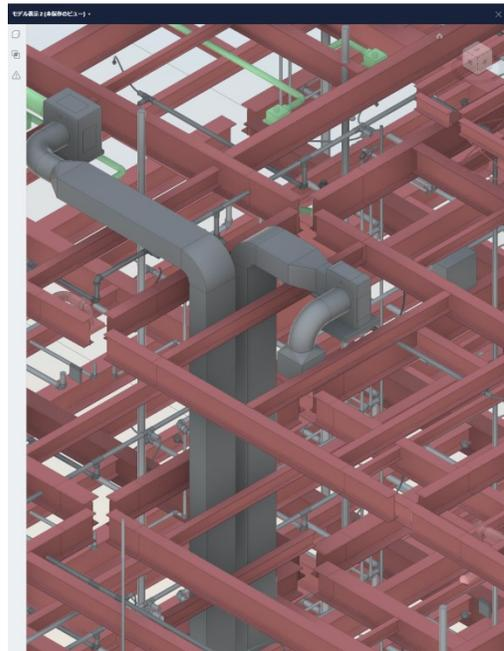
鉄骨梁と配管の干渉
