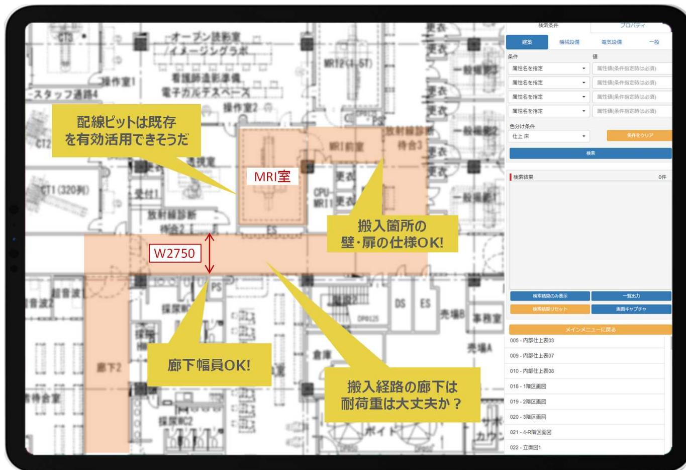
利用シーン2：設備機器の点検・入替え時
