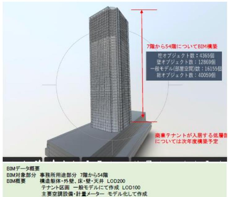
図3 施設全体のBIMデータ概要イメージ
