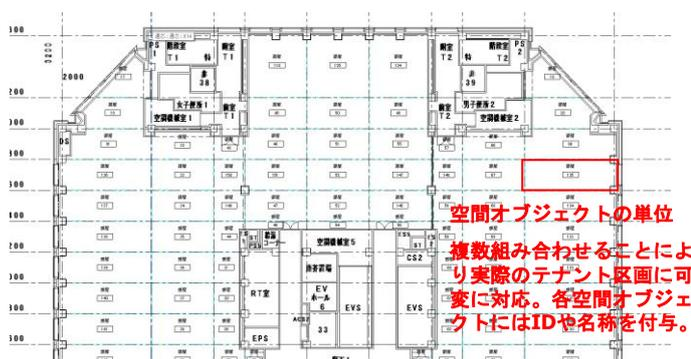
図7 空間オブジェクトによるテナント区画の BIM 構築
