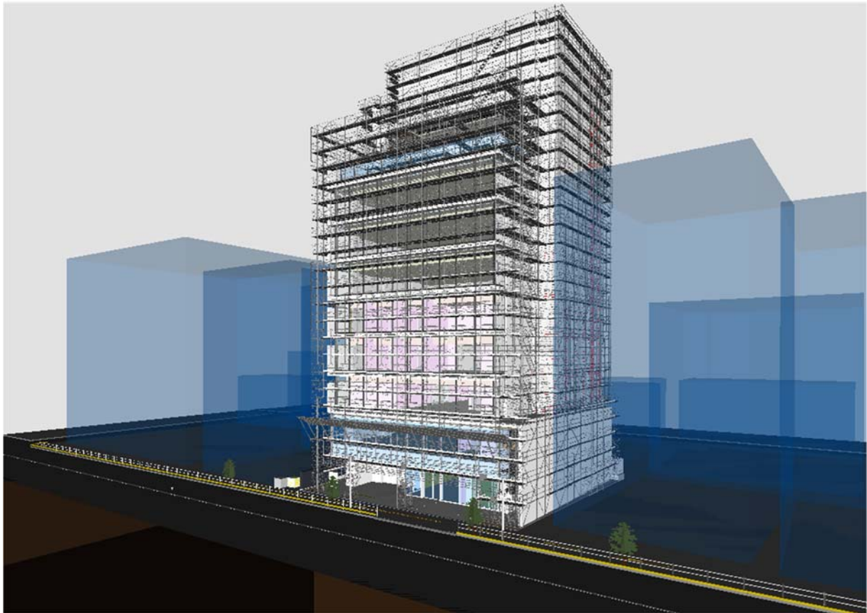
【参考資料 3-10】維持管理 BIM で準備した外部足場
